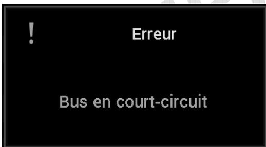
Le fil noir du bus Topline sur lequel transitent les données est en court-circuit avec un des 2 autres fils. Ce court-circuit peut être localisé dans un câble, une boîte de connexion ou un des éléments branchés sur le bus.
