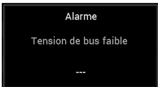
Ce message s'affiche lorsque la tension d'alimentation du bus Topline est inférieure à 9 volts. Les données sont sauvegardées et l'installation s'arrête de fonctionner. Vérifier votre tension batterie et éventuellement la recharger.
